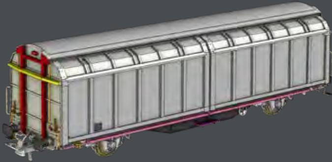
Zweiachsiger Güterwagen mit zweiteiligen Aluminium-Schiebewänden und sechs verriegelbaren Trennwänden. Wenn's empfindlich wird: Dieser großräumige Wagen ist mit Schiebe-
