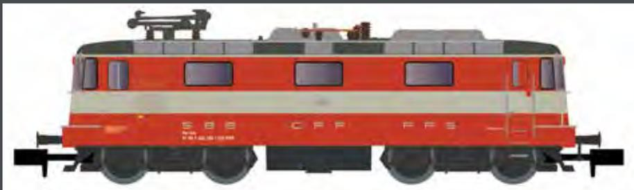
Lok mit Einholmpantograph, Halogen-Scheinwerfern und Klimaanlage. Sie war die letzte im Dienst befindliche Swiss Express Lok.
