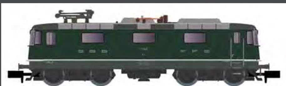
Lok mit Einholmpantograph und Halogen-Scheinwerfern.
