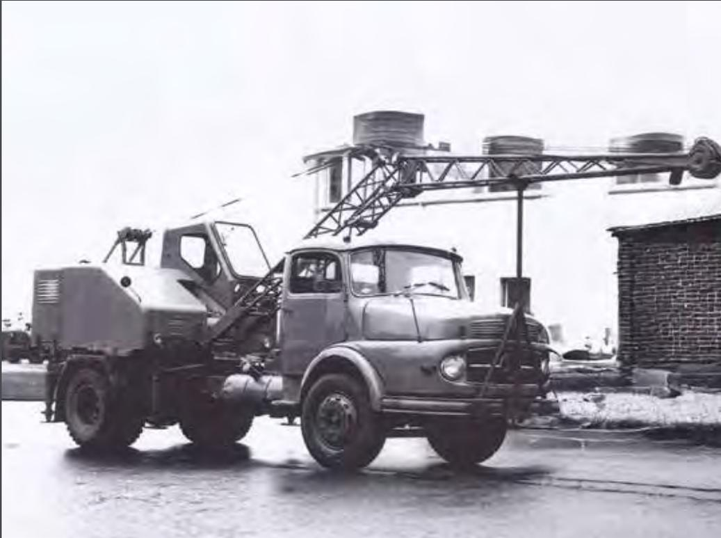
Die Firma Fuchs erkannte früh die Vorteile Ihre Kran- bzw. Bagger-Oberwagen mit einem LKW-Chassis zu kombinieren. So wurden die Oberwagen auf Büssing, Mercedes und sogar auf aus-rangierte Lastkraftwagen des US Militärs montiert. Der ab 1958 gebaute Mercedes Rundhauber wurde mit dem Oberwagen des Fuchs F301 vereint und als Autodrehkran angeboten. Das Fahrzeug konnte sowohl als Kran als auch als Bagger ausgerüstet werden.
