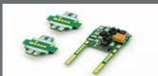
**K101716-D1** DECODERSATZ ET 425 - 2X FUNKTIONSDECODER, 1X FAHRDECODER
